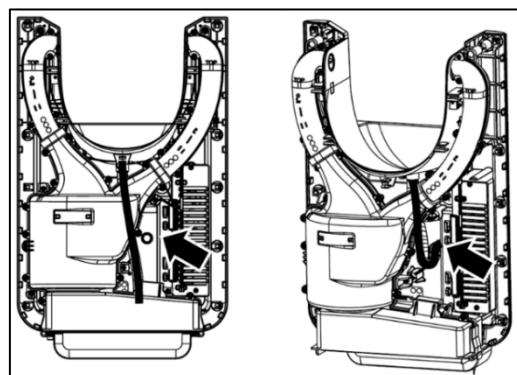
Schließen Sie den mit der Maschine gelieferten Schlauch an den Abfluss an der Rückseite der Maschine an. Montieren Sie die Maschine an der Wand und berücksichtigen Sie dabei, dass der an der Maschine montierte Schlauch in den Wandablauf münden muss.
