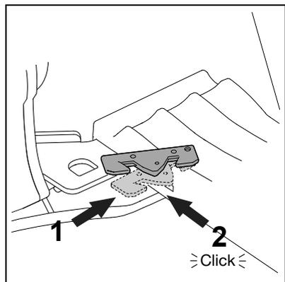
Zum Einsetzen, Sitzring bei 30° halten, 1. **Klinge** in vorgesehene Öffnung **einsetzen**, 2. Klinge nach hinten **drücken**, bis sie einrastet **\*click\***.
