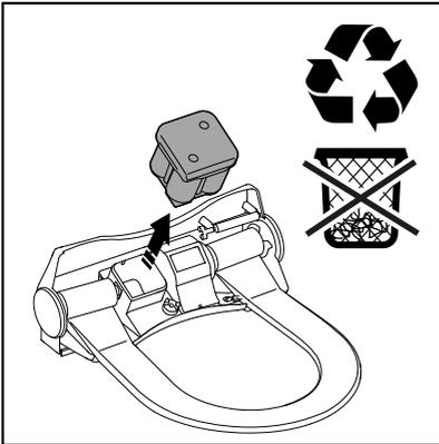
Gerät öffnen (S. 7). Leeres PowerPack entnehmen.
