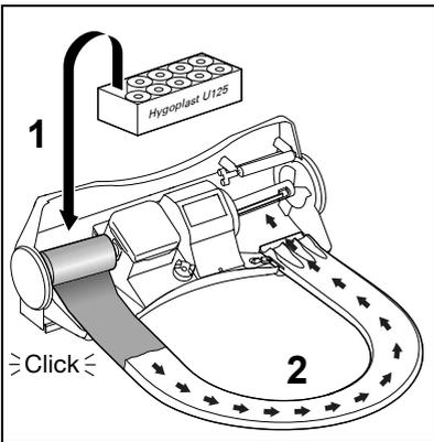
**Neue Hygoplast-Rolle einsetzen** \*click\*. Folie **über Sitzring** sowie **Klinge ziehen**.
