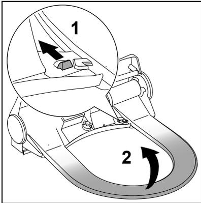
Gerät Öffnen (S. 7). Grauen **Plastikclip** nach hinten drücken, anschliessend **Sitzring** mit linker Hand bis 30° **anheben**.
