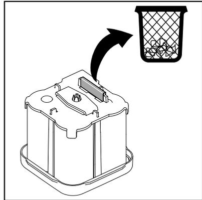
Schutzkappe von PowerPack entfernen und entsorgen.
