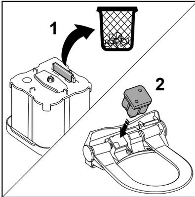
Gerät Öffnen (S. 7). **Schutzabdeckung** vom PowerPack **entfernen**. In **Öffnung einführen** und einrasten (S.10). Gerät schliessen (S. 7).
