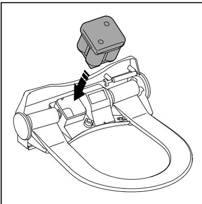
Batterie in Schacht einführen und einrasten.
