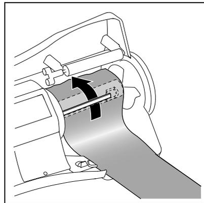
**Ca. 5 cm Folie unter Clip einführen. Abdeckung schließen** (S. 7), Sensor aktivieren. Zählwerk wird nach 2-3 Aktivierungen zurückgesetzt.
