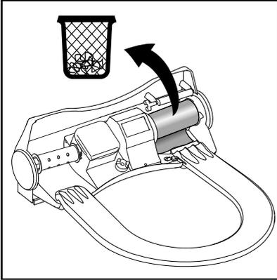
Gerät öffnen (S. 7). **Rechte Seite:** **Benutzte Hygoplast-Folie** inklusive Aufwickelkern **entfernen** und entsorgen.
