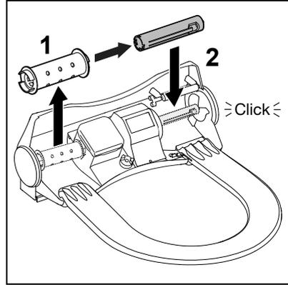
**Linke Seite:** Aufwickelkern aus fertig abgewickelter Folien-Halterung **entnehmen** und auf rechter Seite als **Aufwickelkern einsetzen**.
